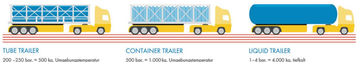
Bild 20. Straßentransport von Wasserstoff (Quelle: Shell)
